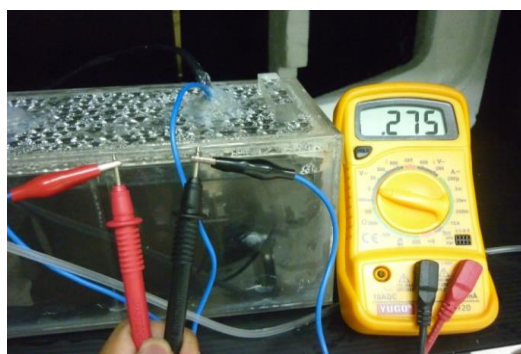
ภาพที่ 1 ลักษณะของเซลล์เชื้อเพลิงชนิดห้องคู่ (TCB-MFC) ที่ใช้ในการเพาะเลี้ยง R. sphaeroides
